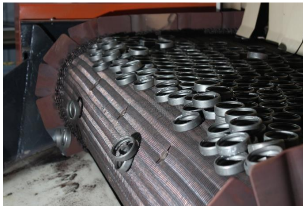
Piec elektryczny WD-HH-100x14 – z taśmą siatkową, z płukaniem.
