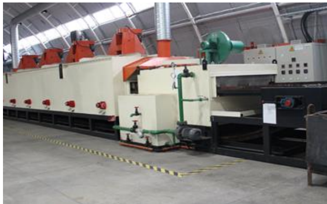
Agregat do termicznej obróbki półfabrykatów pierścieni łożysk – piec elektryczny WD-HH-100x14.
