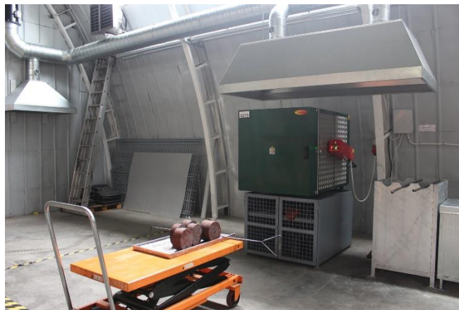
Piec KPM120/1200 do hartowania i odpuszczania detali
