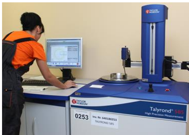
Urządzenie do pomiaru okrągłości Talyrond 585 RSU (TAYLOR HOBSON, Wielka Brytania)
