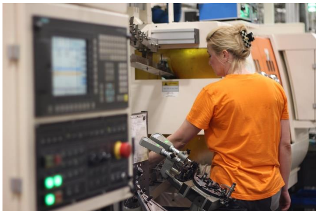
Wybiórcza kontrola pierścieni w procesie wykonywania operacji szlifierskich
