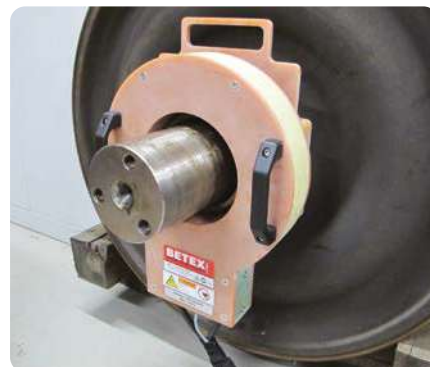
Nagrzewanie pierścieni labiryntowych do demontażu
