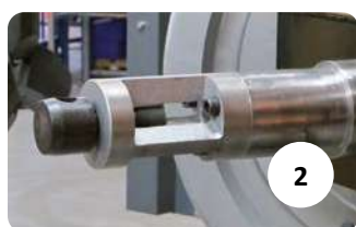
Stopniowy montaż zespołów łożyskowych TBU / SP / TAROL
