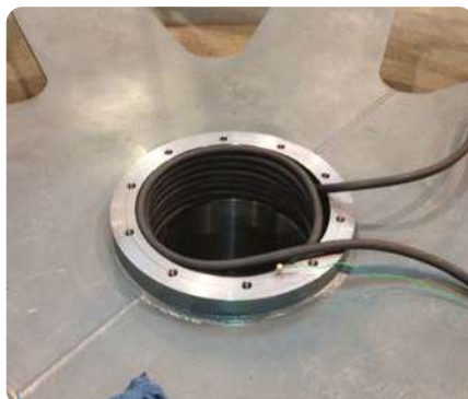
Nagrzewanie otworów przed montażem łożysk lub wałów
