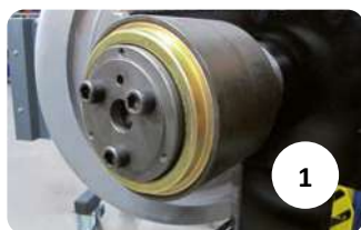
Stopniowy demontaż zespołów łożyskowych TBU / SP / TAROL
