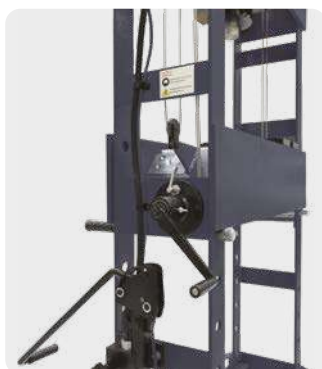
Wysokość stołu prasy regulowana na wyciągu
