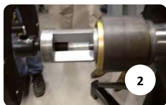
Stopniowy demontaż zespołów łożyskowych TBU / SP / TAROL
