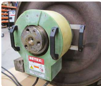
Nagrzewanie łożysk do demontażu
