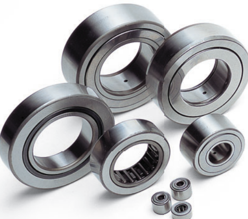
Roller Followers (STEEL) ローラフォロア (スチールタイプ) 外輪が肉厚で、大きなラジアル荷重を支持できます。外輪回転用に設計されたベアリングです。 Our roller followers have a thick outer ring to support large radial loads. This bearing is designed for applications where the outer ring rotates.
