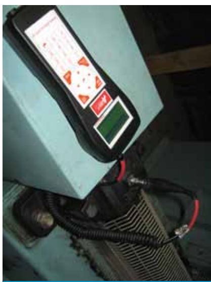
ZDJ. 3. Detektor drgań z czujnikiem piezoelektrycznym
