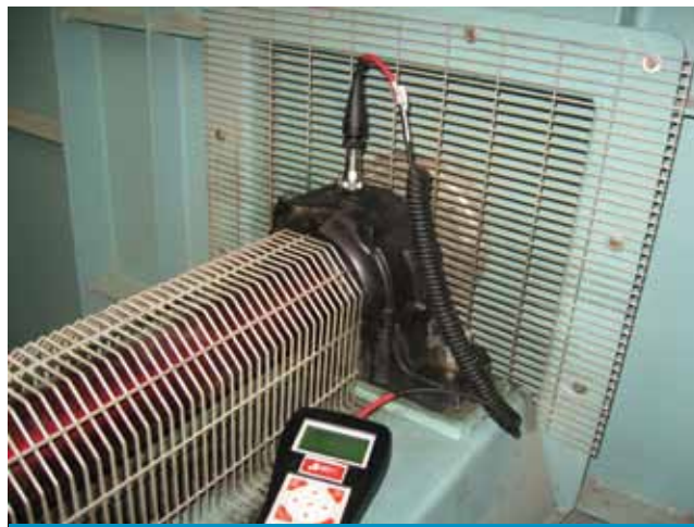
ZDJ. 2. Pomiar drgań łożyskowania wału
