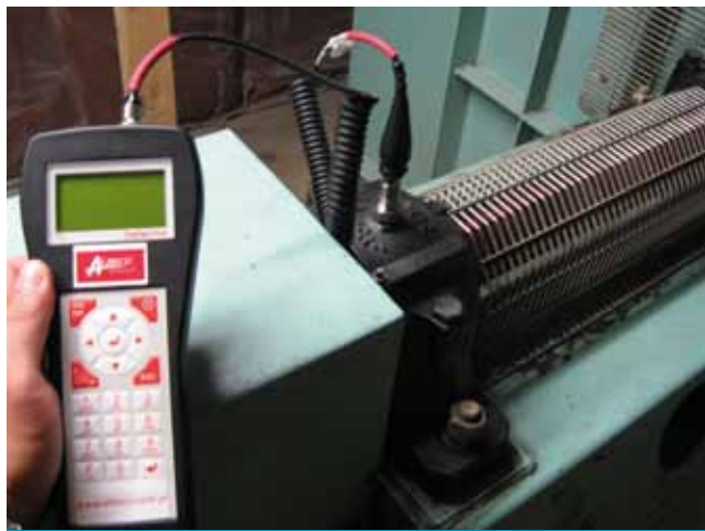
ZDJ. 4. Pomiar łożyskowania wału
