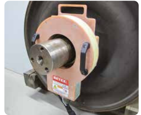
Nagrzewanie pierścieni labiryntowych do demontażu
