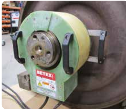
Nagrzewanie łożysk do demontażu
