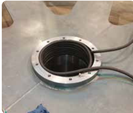
Nagrzewanie otworów przed montażem łożysk lub wałów
