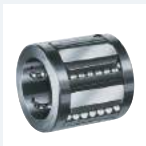
Segmentowa tuleja toczna R0668.. normalna R0668.. odporna na korozję średnica wału 12 – 40 mm Kulki wykonane ze stali łożyskowej, hartowane segmenty stalowe, koszyczek prowadzący z poliamidu
