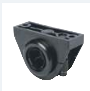
Zestaw liniowy nastawialny R1060.. normalny R1060.. odporny na korozję średnica wału 12 – 40 mm Obudowa łożyska stojakowego ze wzmocnionego poliamidu z segmentową tuleją toczną, dwa wymienne pierścienie uszczelniające, regulowany luz promieniowy
