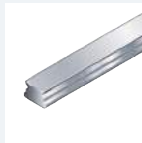
Miniaturowa szyna prowadząca, standardowa R0445.. wielkości 9, 12, 15, 20 Przykręcana od góry, z taśmą osłonową ze stali sprężynowej, odporna na korozję zgodnie z DIN EN 10088 Wielkość 15 dostępna także w wersji przykręcanej od dołu
