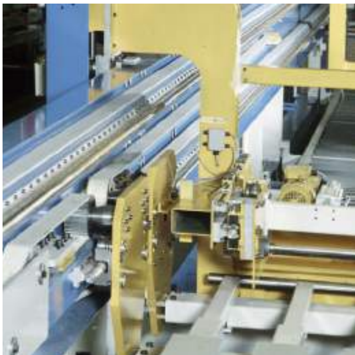
Precyzyjny wał stalowy R0724 0 , z czterema rowkami w powierzchni tocznej, wał wydrążony
