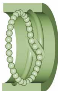
Rys. 3.5: Obieg kulek przy wewnętrznym mechanizmie przekierowania kulek
