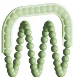
Rys. 3.4: Obieg kulek przy zewnętrznym mechanizmie przekierowania kulek
